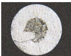
Elgacore® Matrix langan poikkileikkaus, erittäin johdonmukainen, pyöreä ja tiukka.
