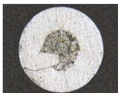
Sezione di Elgacore® Matrix: giunzione liscia, compatta e regolare.
