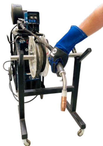
Test podawania drutu – palnik 4.5 m z 3 pętlami
