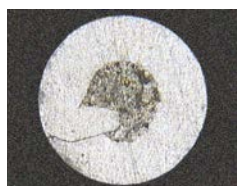
ELGACORE® MATRIX - przekrój poprzeczny szwu pokazuje jego wysoką spójność, gładkość i szczelność.
